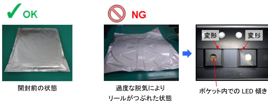
図 1. 過度な脱気状態によるエンボスキャリアテープの変形
